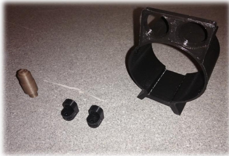
Rys. 3 Elementy wydrukowane na drukarce 3D. Od lewej: dysza, uchwyty do tacki i podstawka pod głośnik i czujnik.
