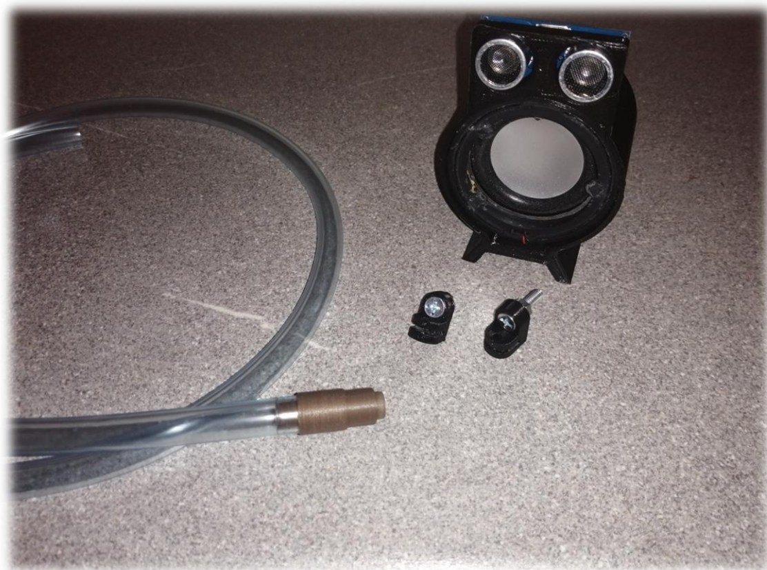
Rys. 5 Elementy wydrukowane na drukarce 3D z komponentami: dysza z węzłem PCV, uchwyty do tacki ze śrubkami i nakrętkami oraz podstawka z głośnikiem i czujnikiem ultradźwiękowym.
